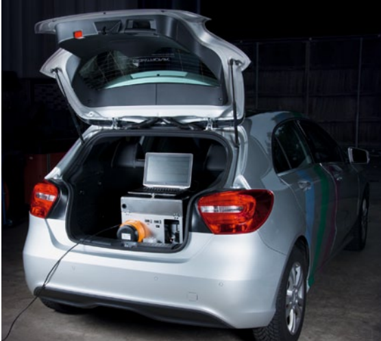
③ Werkstattladevorgang der Messtechnik und PC zur Konfiguration, der über die USB-Schnittstelle oder via Bluetooth an das PowerAider-System angeschlossen ist
